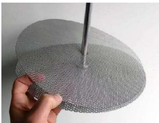
наденьте вторую трубку с фиксаторами поверх трубки, которую только что присоединили к нижней перфорированной пластине. Надевать эту трубку полностью, до самого низа, необязательно.
